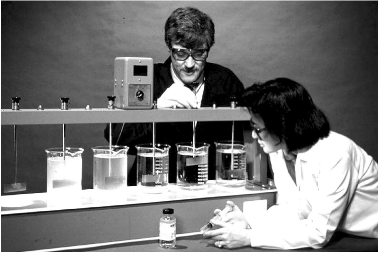
รูปที่ 2.4 แสดงการทดลองจาร์เทสต์
